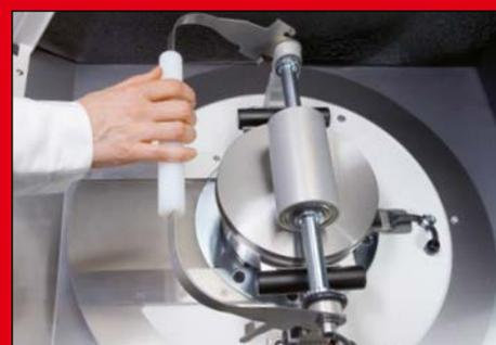
**Particularmente seguro:** En cuestión de segundos se somete a tensión con una sola mano y un solo movimiento, el completamente nuevo tensor rápido y anti-rotatorio para el set de molienda.
