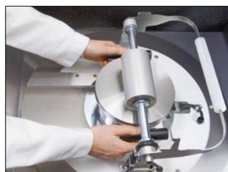
**Particularmente ergonómico:** Los sets de molienda PULVERISETTE 9, que se han reducido considerablemente en peso, se colocan a una altura de trabajo optimizado sobre un carril guía práctico y posteriormente se mueven de forma fácil hacia la posición final.
