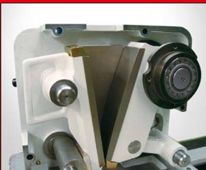
Vista de la cámara de molienda con la cubierta removida.
