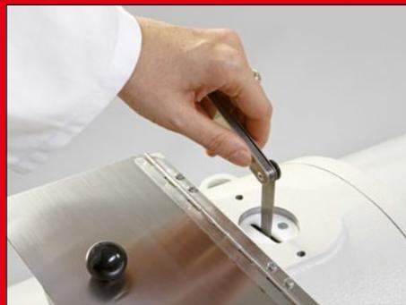
**Particularmente práctico:** fácil revisión de la anchura del espacio desde la parte superior (por ejemplo, con un medidor de grosor).
