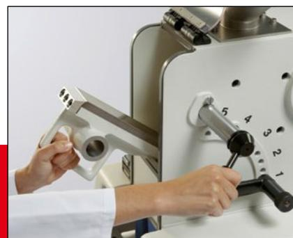
Ahorre tiempo y energía: la extracción de la Trituradora de Mandíbula especialmente sencilla toma tan sólo unos segundos y requiere únicamente dos movimientos manuales para asegurar una limpieza particularmente sencilla y completa.
