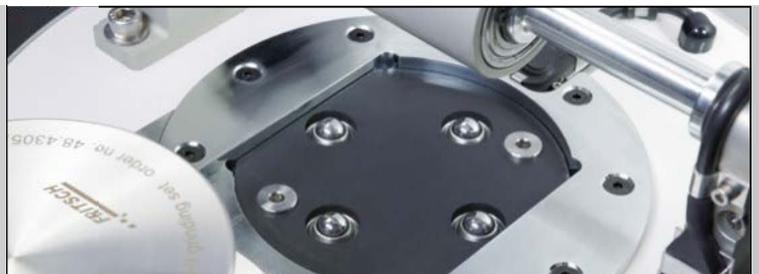
Los elementos de presión elevan automáticamente el set de molienda, el cierre amortiguador las presiona perfectamente de forma segura y el interruptor de seguridad revisa que la posición esté firme.
