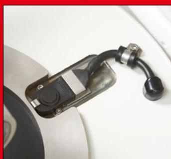
**Particularmente inteligente:** Un detector especial que automáticamente detecta cuando usted utiliza un set de molienda ágata y reduce la velocidad giratoria de forma independiente.
