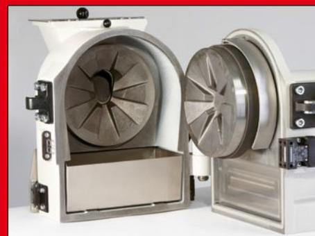
**Particularmente ahorrador de tiempo:** la cámara de molienda puede abrirse completamente, la cual hace que la limpieza sea prácticamente sencilla y los discos de molienda sean fácil y accesibles para intercambiarse.
