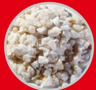
3 Resultado final de PULVERISETTE 13. Finura final inferior a 100  $\mu\text{m}$
